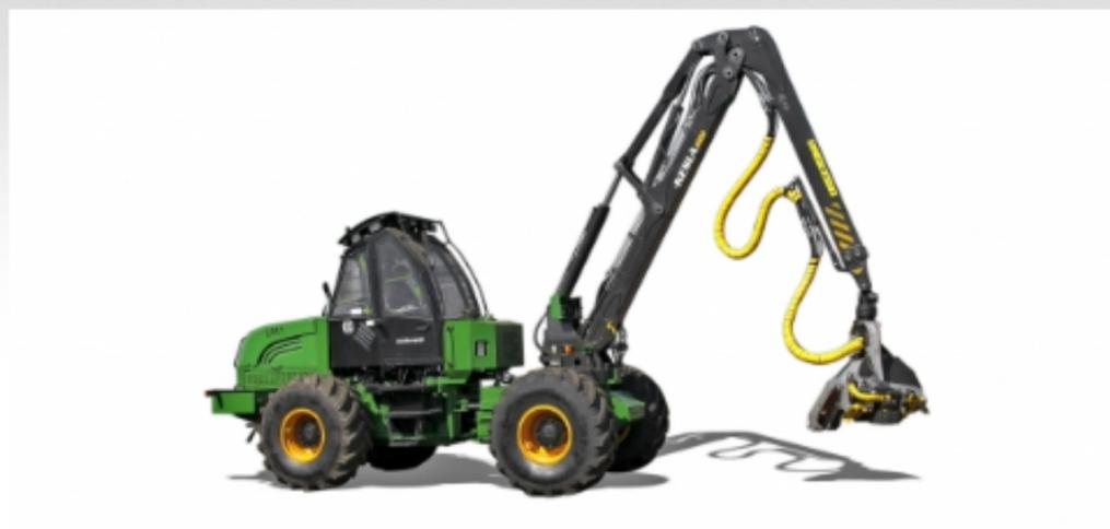
Харвестер АМКОДОР 2541 предназначен для валки деревьев, обрезки сучьев и раскряжевки хлыстов на сортименты заранее заданной длины при проведении проходных рубок.
