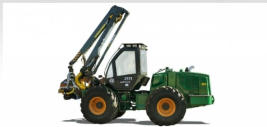
Харвестер АМКОДОР 2531 – компактная малогабаритная машина, предназначенная для валки деревьев, обрезки сучьев и раскряжевки хлыстов на сортименты заранее заданной длины при выполнении рубок ухода (прореживания).
