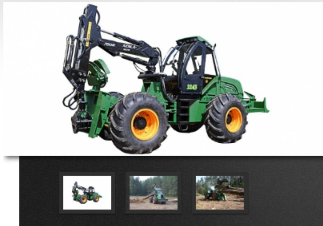
Тягач трелевочный АМКОДОР 2243 предназначен для трелевки деревьев и хлыстов, а также для выполнения вспомогательных работ на лесосеке: подготовки погрузочных площадок, штабелирования хлыстов, выравнивания комлей.
